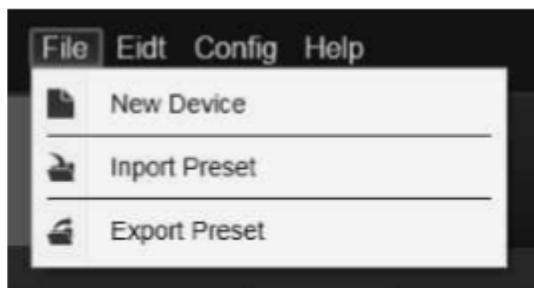
2. En la opción New Device (nuevo dispositivo), seleccione el tipo de dispositivo S13.4 o S15.2, Device ID (identificación del dispositivo) y complete el nombre en Device Tag.
