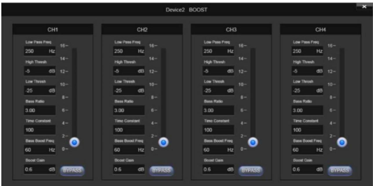
**Lowpass Freq:** La frecuencia de paso bajo oscila entre 20 Hz y 250 hz. El detector utiliza las frecuencias que se encuentran por debajo del punto seleccionado para determinar el nivel de acentuación.
