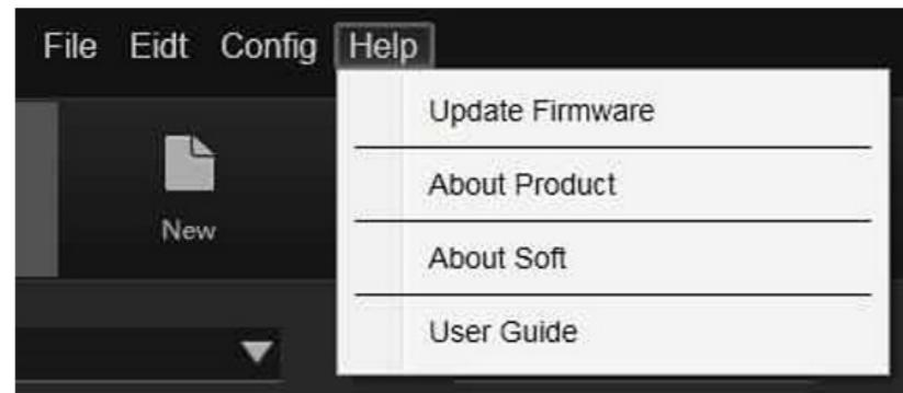
2. Update firmware: Para actualizar el firmware, presione las teclas BACK y ENTER del dispositivo correspondiente. Luego inicie dicho dispositivo, ejecute el software y diríjase a la página de actualización y seleccione el firmware. El proceso de actualización puede tomar cierto tiempo.
